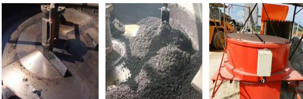
Figura 5: Vista das paletas misturadoras e aspecto homogêneo da mistura obtida com o equipamento J-1000
