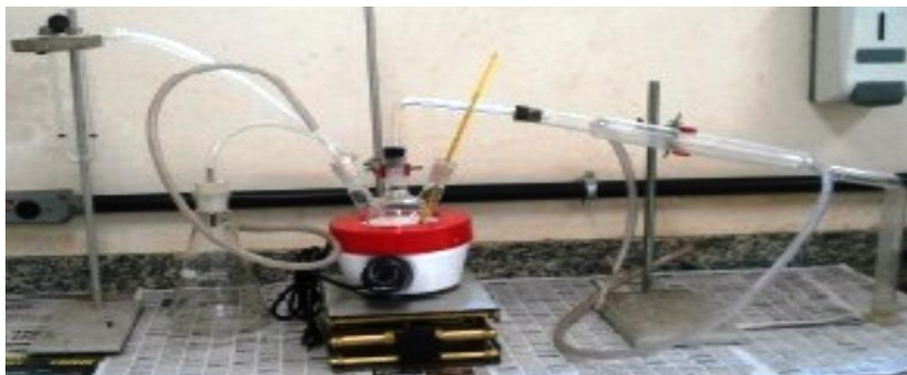
Figura 8: Equipamento Utilizado para Destilação em Presença de no CO 2 Laboratório do IME (COSTA e GUIMARÃES, 2012)
